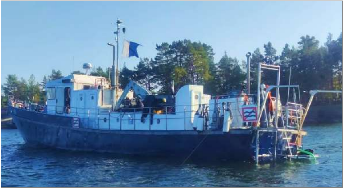
Kuva 19. MAS:n lippulaiva DSV Stella ankkuroituna Hamnholmarnan rannassa. Aluksen perässä näkyy sukeltajahissi ja sen vieressä uimatasolla ejektoripumppu ja sen imuletku. ”Vältä aaltoja” merkit ovat tätä päivää.
